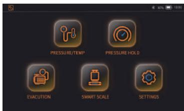
Esta é a tela principal da interface quando o dispositivo é ligado. Existem "Medição de pressão e temperatura", "Medição de retenção de pressão", "Escala eletrônica de refrigerante" e "Configuração" para seleção. Clique no ícone para entrar em cada uma das funções correspondentes. A barra de status no topo da página exibe a hora, indicador de energia / bateria, conexão sem fio e status de gravação.
